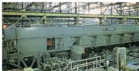
中径シームレス管水圧試験機 (Hydrostatic Pipe Tester for medium dia. pipe)
