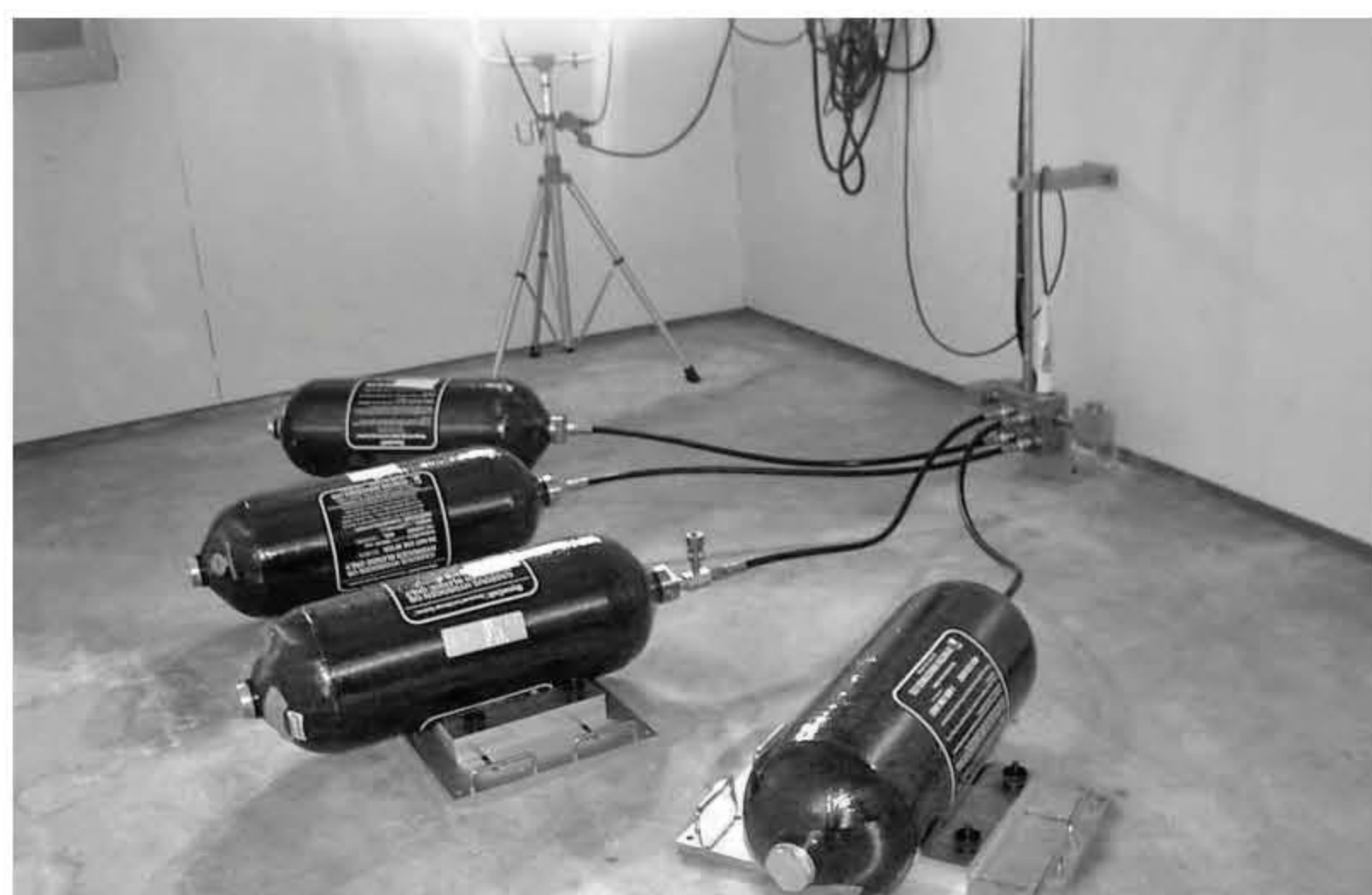
写真5 ピット内試験容器接続図
